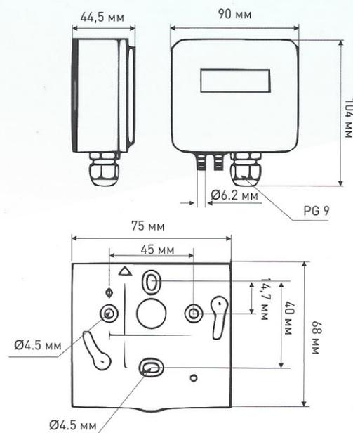
Датчик давления воздуха LFM11 определяет давление в каналах систем вентиляции, а затем преобразует давление или разницу давлений в пропорциональный аналоговый выходной сигнал. Датчики были специально разработаны для автоматизации систем HVAC, мониторинга давления и расхода, а также для испытаний на низкий перепад давления в промышленности.
